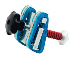
Применяется для фиксации седлового отвода к полиэтиленовой трубе перед электромуфтовой сваркой. Фиксация позиционера с седловым отводом к трубе осуществляется с помощью стяжных ремней.
